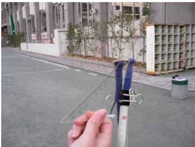
図4 測量に用いた直角二等辺三角形の定規
