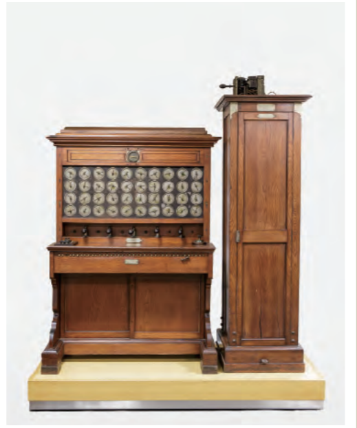
● 川口式電気集計機 人口動態統計調査の集計を行うため考案製作されたもの
