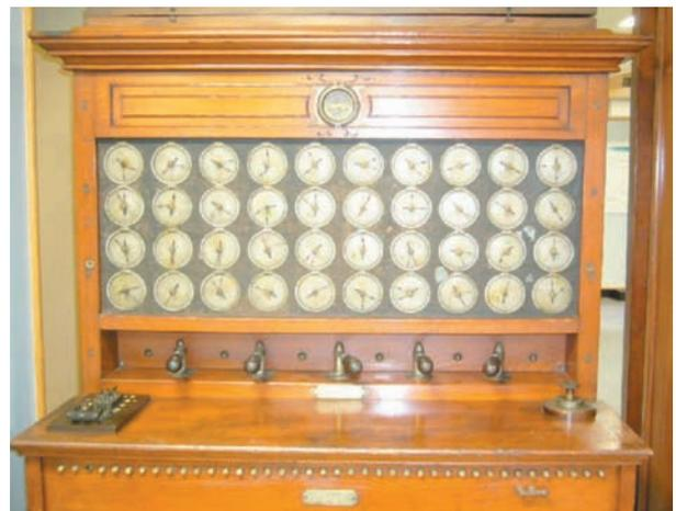
「亀の子型穿孔機」を用いて作成した計牌を接触器上部の挿入器に挿入し、ハンドル操作することで、中にある分類針（送電針と受信針）がカードの穿孔箇所て接触すると電流を通じ、計盤台にある時計型計器の長針が1目盛り分（1枚分）進む方式となっています。
