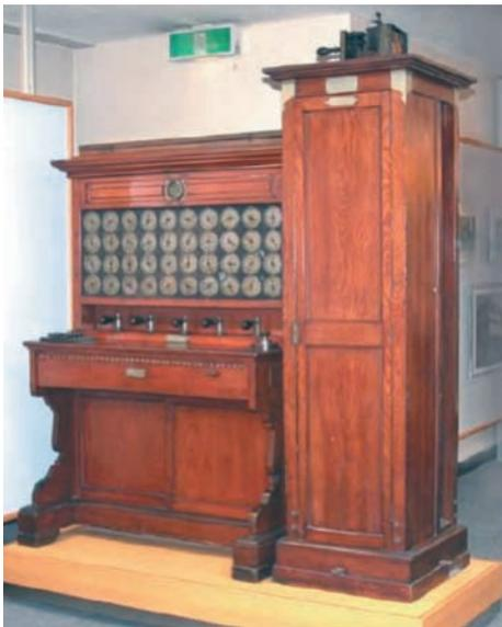
川口式電気集計機は、明治35年に「国勢調査ニ関スル法律」が公布された時、調査結果の効率的な集計のためには国内における統計機械の開発が必要という考えから、政府が内閣を通じて通信省に依頼、これを受けて同省電信燈台用品製造所技師川口市太郎氏が研究・開発に着手し、考案された我が国初の統計集計機です。
